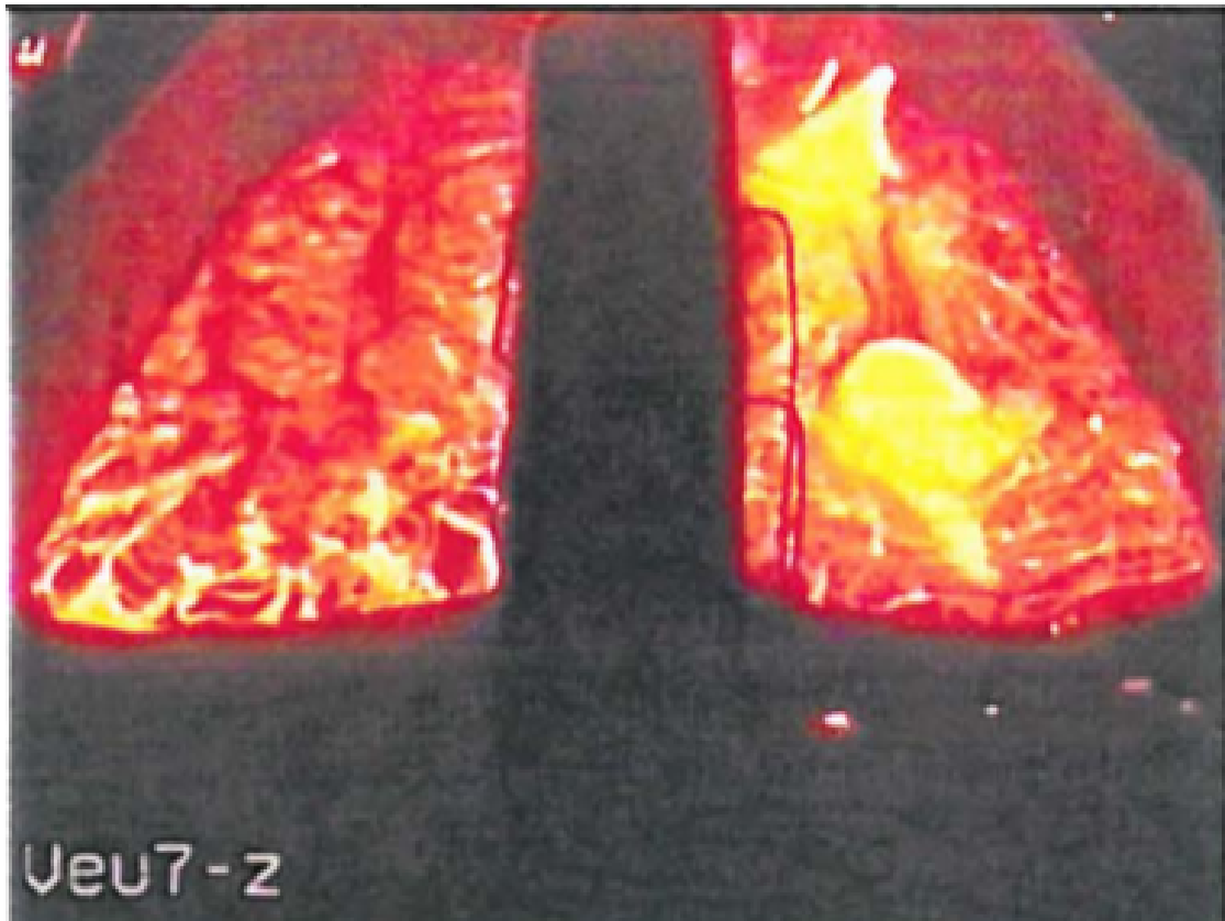
FIGURE 2.2 – Vue de l’essai VEU7 à t = 8.24s . La section à gauche de l’image a un substrat en céramique tandis que celle de droite a un substrat en béton siliceux. On observe sur cette dernière un dégazage important localement. [57]
